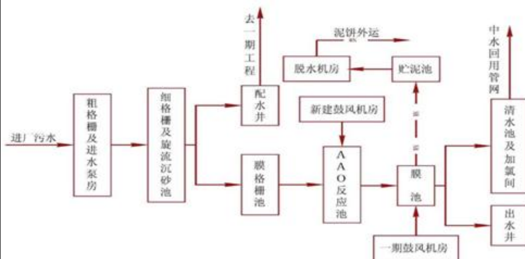
图 4-2 污水处理厂二期废水处理工艺流程简图
